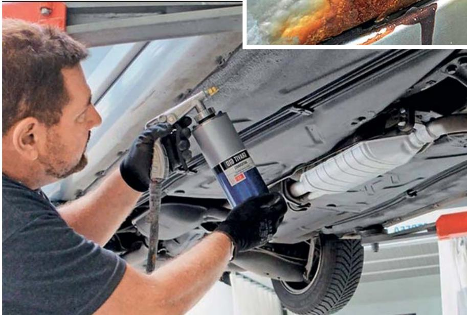
моментом машины завальцовка задних арок по кромке отходит в прошлое, а передние крылья давно штамуются из одного листа, и внутренняя их часть не имеет ни цинкового слоя, ни антигравийной защиты. Зато накопление влаги и механические повреждения таких поверхностей случаются часто.
