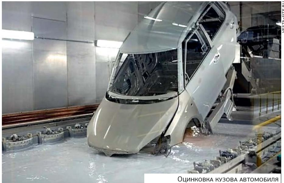
Оцинковка кузова автомобиля
